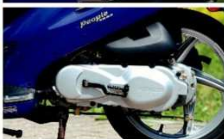
Na visoke kotače od 16" montiraju se vrlo uske gume dimenzija od svega 80 naprijed i 100 straga
