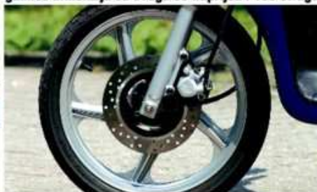
Na visoke kotače od 16" montiraju se vrlo uske gume dimenzija od svega 80 naprijed i 100 straga
