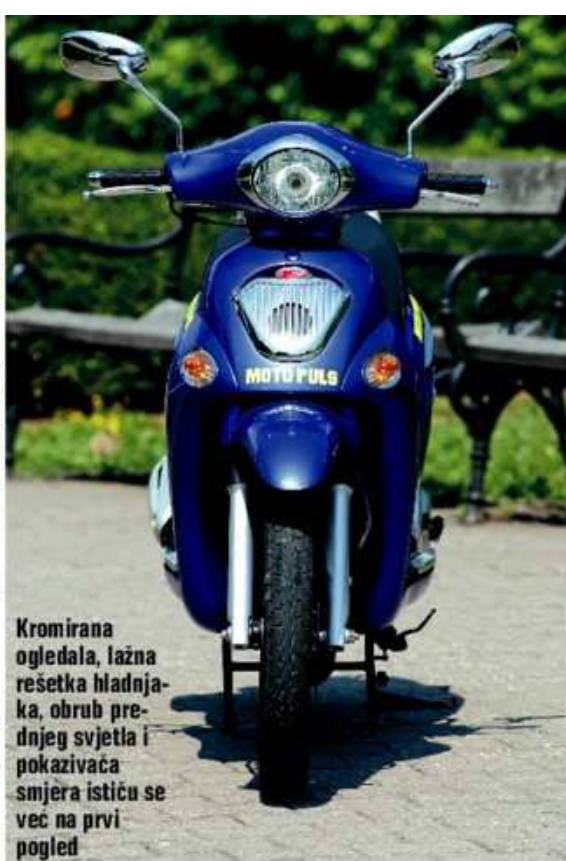
Na visoke kotače od 16" montiraju se vrlo uske gume dimenzija od svega 80 naprijed i 100 straga
